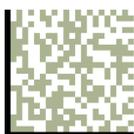
Zwei durchgängige Begrenzungslinien („Find Pattern“) bilden eine „Ecke“ und dienen dem Scanner zur Identifikation, ob ein willkürliches Muster aus hellen und dunklen „Flecken“ oder ein DMC vorliegt.
